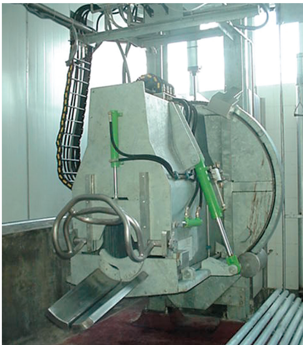
Fig. N° 14. Box rotativo ROVANI. Frigorífico Establecimientos Colonia S.A.
