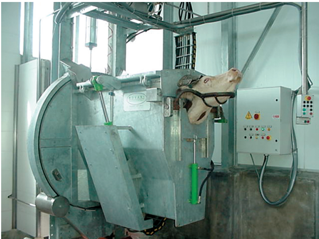
Fig. N° 13. Cajón rotativo de doble propósito ROVANI: faena estándar o ritual. Frigorífico Establecimientos Colonia S.A. Departamento de Colonia.
