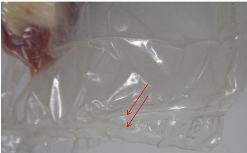
Figura 37: Sellado defectuoso, doble costura (Defecto Menor).
