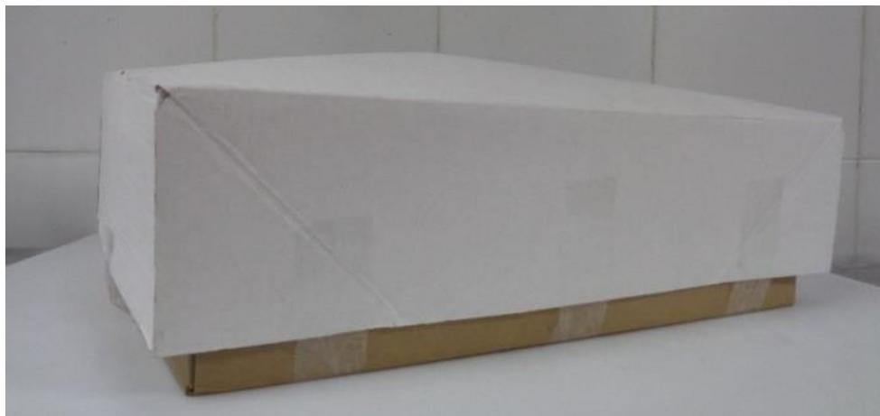
Figura 41: Relación producto/envase inadecuada que genere una deformación de la caja (Defecto Menor).
